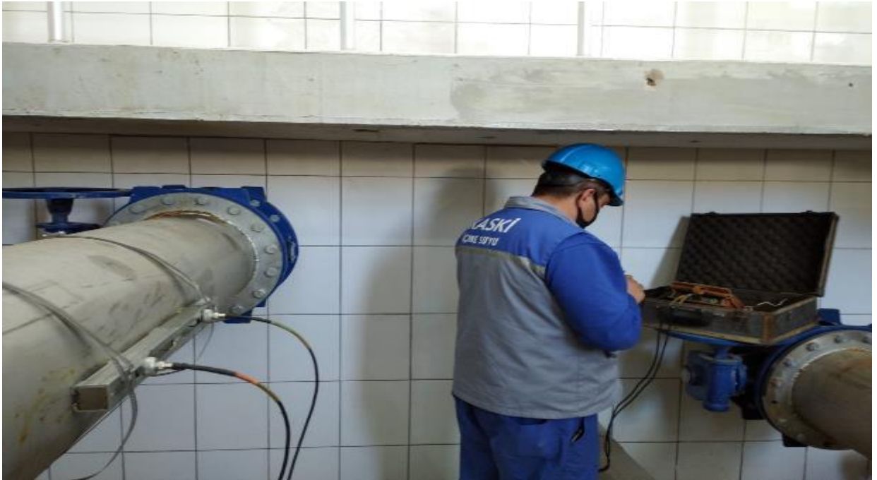
Şekil-7: Depo Çıkışı Debi Ölçümü
